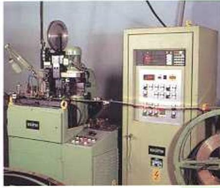
Sección de soldadura automática de contactos de metales finos (plata, oro, etc.) con sus más frecuentes aleaciones (níquel, cobre, estaño), en las bandas de materia prima (latón, bronce, cobre, hierro).
